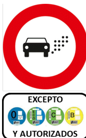
Figura 45. Señalización vertical en los accesos a la zona de bajas Emisiones.
