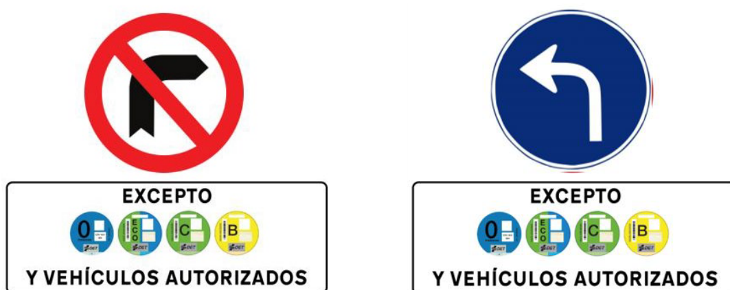
Figura 44. Señalización vertical en los accesos a la zona de bajas Emisiones (giros).
